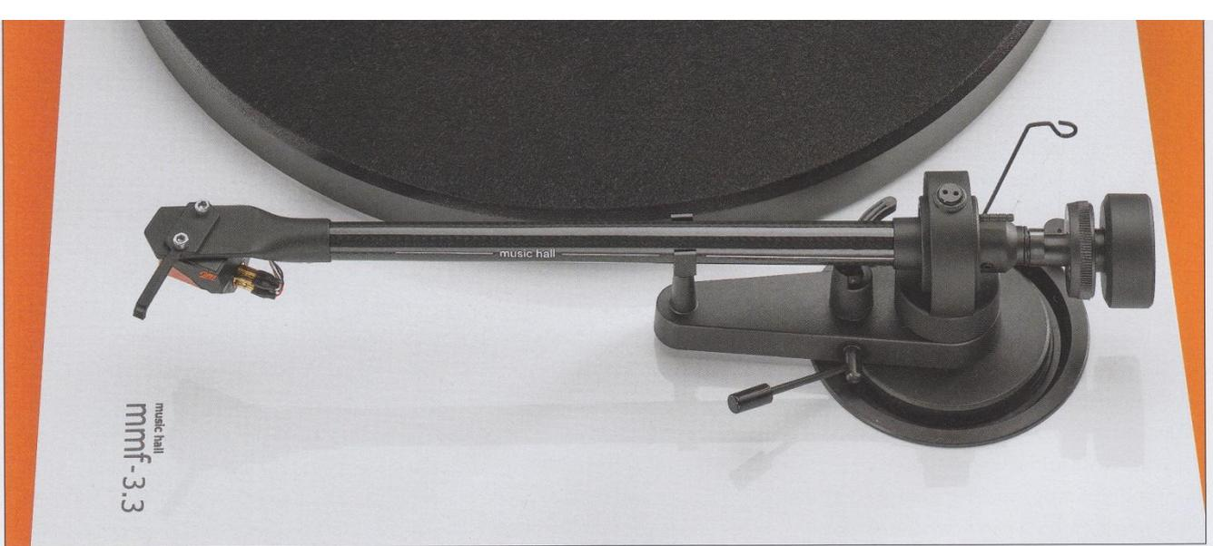
hängung des Tonarms beinhaltet invertierte Lager, deren vier Edelstahl-Spitzen auf Kugellager aufsetzen. Die Einstellung der Antiskating-Kraft erfolgt auf bewährte Weise per Faden und Gewicht; der silikonbedämpfte Tonarmlift senkt den Arm zügig und geschmeidig ab.
