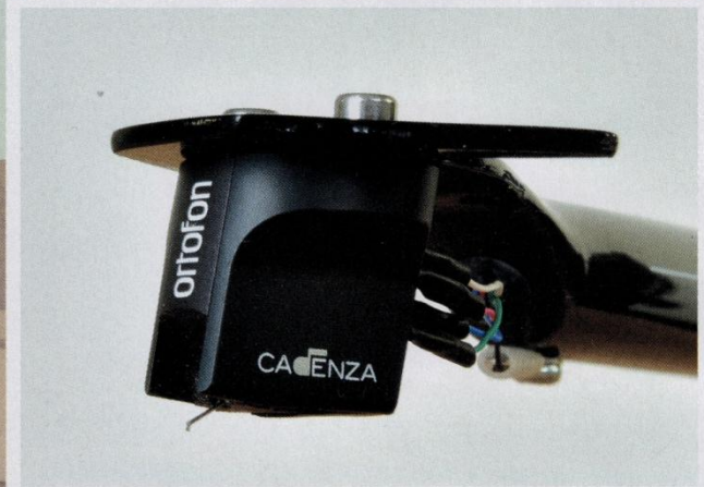
Ortofons Cadenza Black ist ab Werk im mmf-11.3 eingebaut und benötigt noch die übliche Auflagekraft-Justage: 23 Millinewton sind perfekt für das mit zehn Gramm nicht allzu schwere MC, das mit 100 bis 200 Ohm Abschluss gut spielt.
