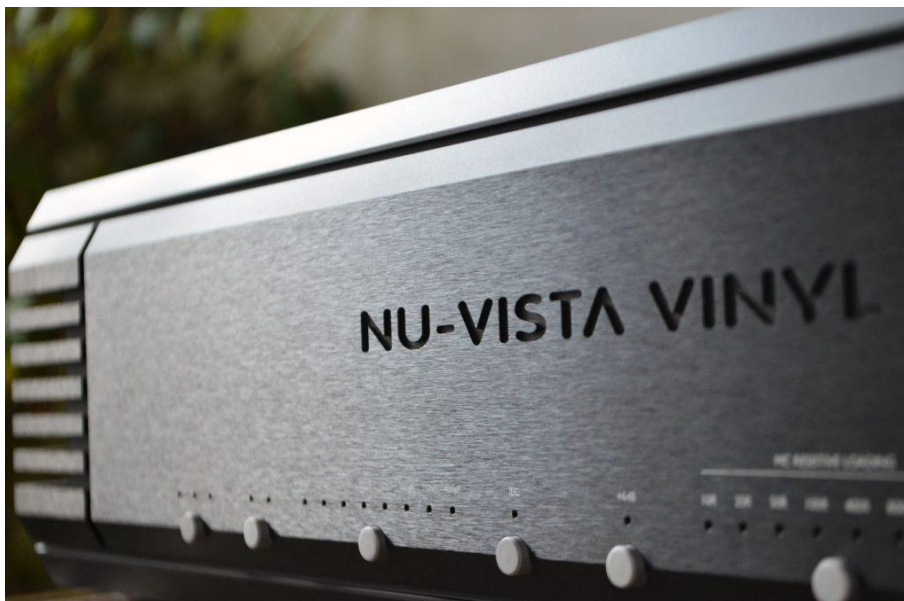
Die Bedienung erfolgt über kleine Drucktasten, die Funktion wird über das Leuchten der jeweiligen LED dezent angedeutet (Foto: H. Biermann)
