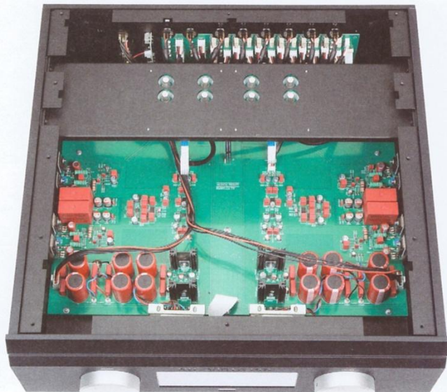
Auch der Vorverstärker besticht durch den kanalgetrennten, symmetrischen Aufbau.
