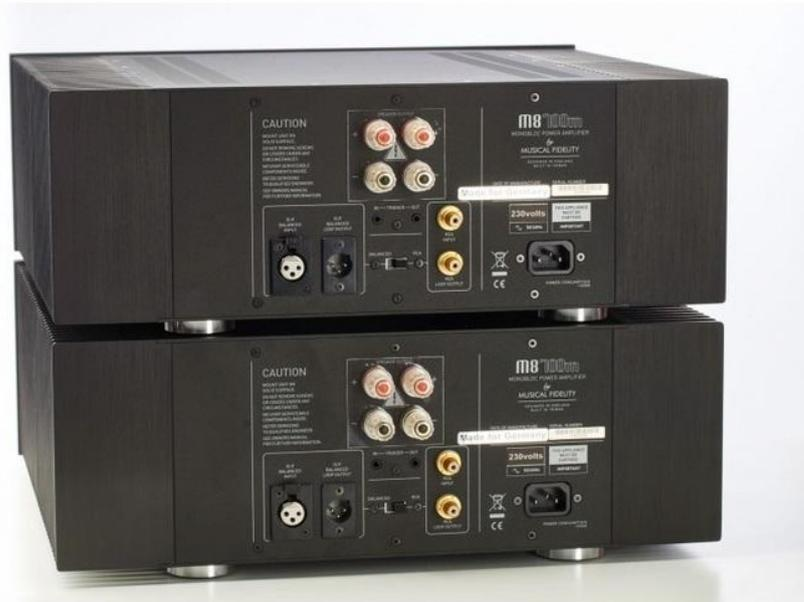
*Vielfältige Anschlussmöglichkeiten: Die Lautsprecherterminals sind aus hochreinen Kupfer. Umschaltbare Eingänge für RCA und XLR und Loop-Out-Verbindungen insbesondere für Bi-Amp Betrieb sowie einen Trigger-Eingang*
