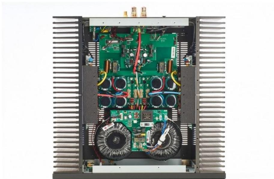
*Vollsymmetrischer Aufbau mit zwei völlig identischen Verstärkerzügen und gebrückter Schaltung*
