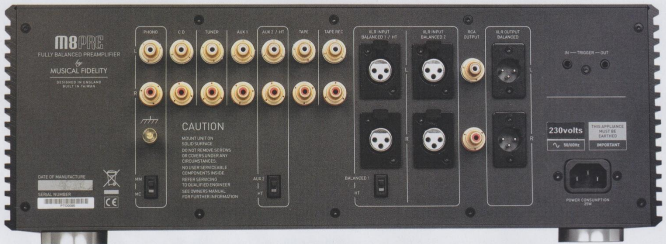
Über Kippschalter lässt sich bei zwei Kanälen der so genannte Bypass einstellen, die Lautstärkeregelung wird nun umgangen. Auch die Phono- und MC-Systeme lassen sich hier zwischen MC- und MM-Systemen umschalten
