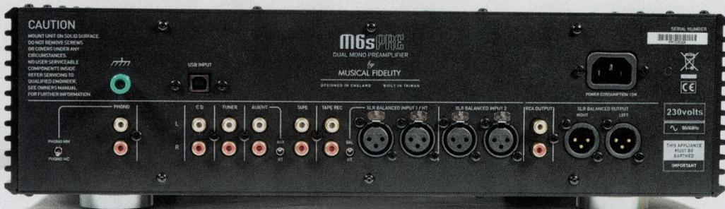
Eine Besonderheit bei Musical Fidelity: Mit „HT“ bezeichnete Eingänge schleifen das Signal wahlweise ohne Lautstärkeregelung direkt auf die Endstufen-Ausgänge durch (Vorsicht, Schalter kontrollieren!)
