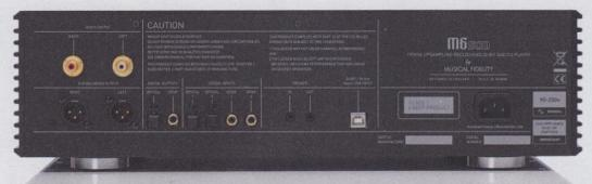
Zusätzlich zu den Standard-Ausgängen offeriert der M6scd darunter ein Paar symmetrische Ausgänge, die im Zweifel wegen des theoretisch besseren Störspannungsabstands vorzuziehen sind. Der USB-Eingang akzeptiert hier nur 96 kHz, während die koaxialen S/PDIF-Kontakte bis 192 Kilohertz reichen. Passende USB-Treiber für Windows sind unter www.musicalfidelity.com unter "Support" zu finden.
