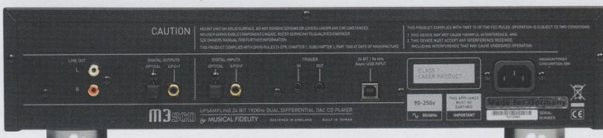
Der CD-Player ist mehr als das Laufwerk. Über USB, optische und koaxiale Wege kann direkt der interne Wandler benutzt werden
