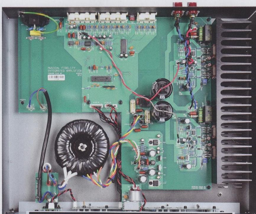
Die SMD-Technik von Musical Fidelity sorgt im M2si für eine kompakte Hauptplatine mit extrem kurzen Signalwegen. Auffallend breit sind die Leiterbahnen ausgeführt.
