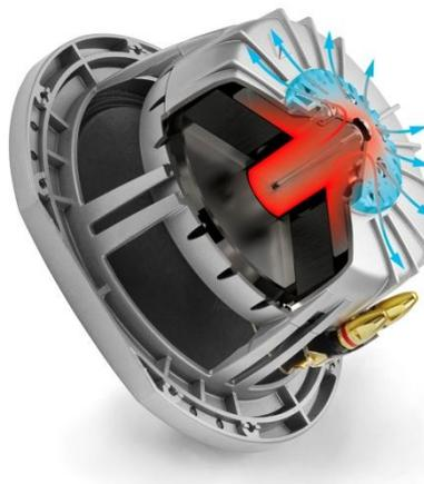
Der TG16GM MT10GC1-V2 verfügt zusätzlich über einen Wärmeübertragungsring, der an der Rückseite des Antriebs platziert ist. Dieser ermöglicht eine effektive Wärmeableitung vom inneren Bereich des Magneten an den Korb des Chassis und verbessert um über 10 % die Belastbarkeit des Wandler.
